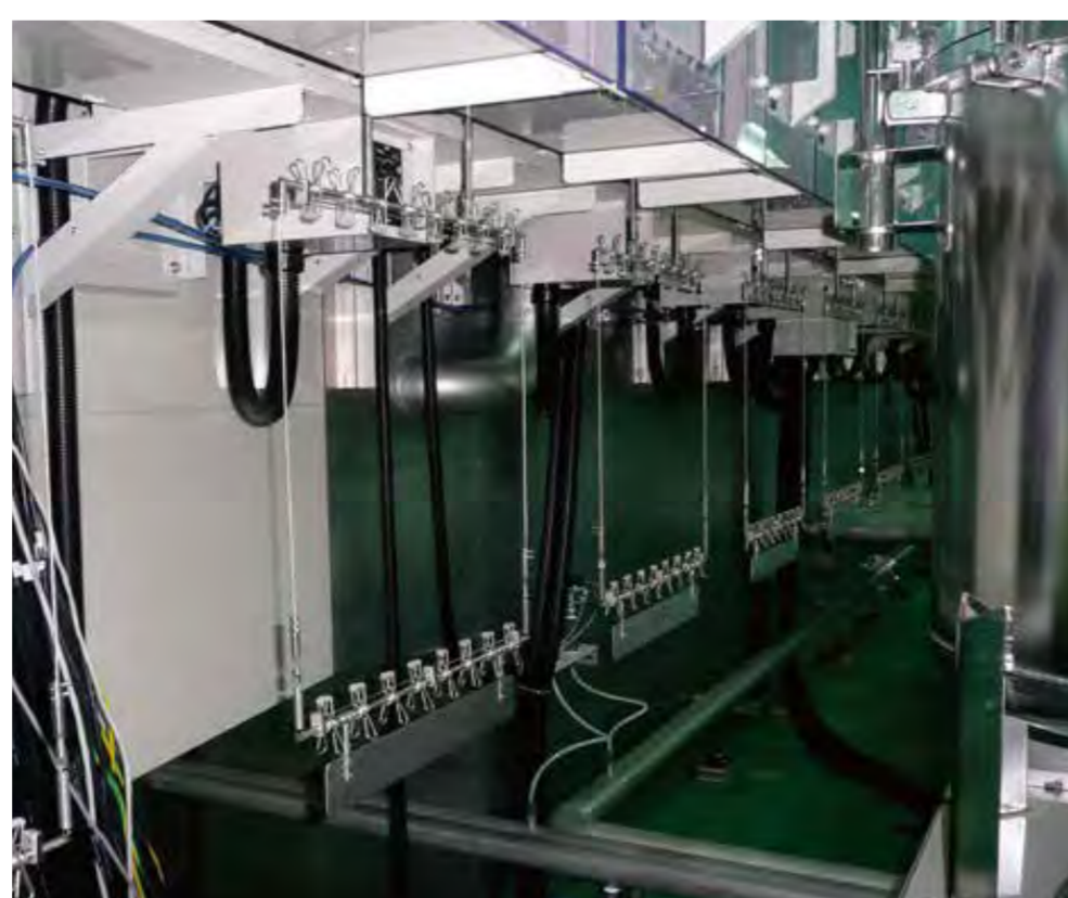
オートローディングの基板搬送治具
