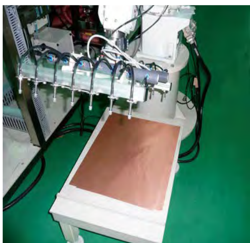
外周吸着での自動ロードアンローダ
