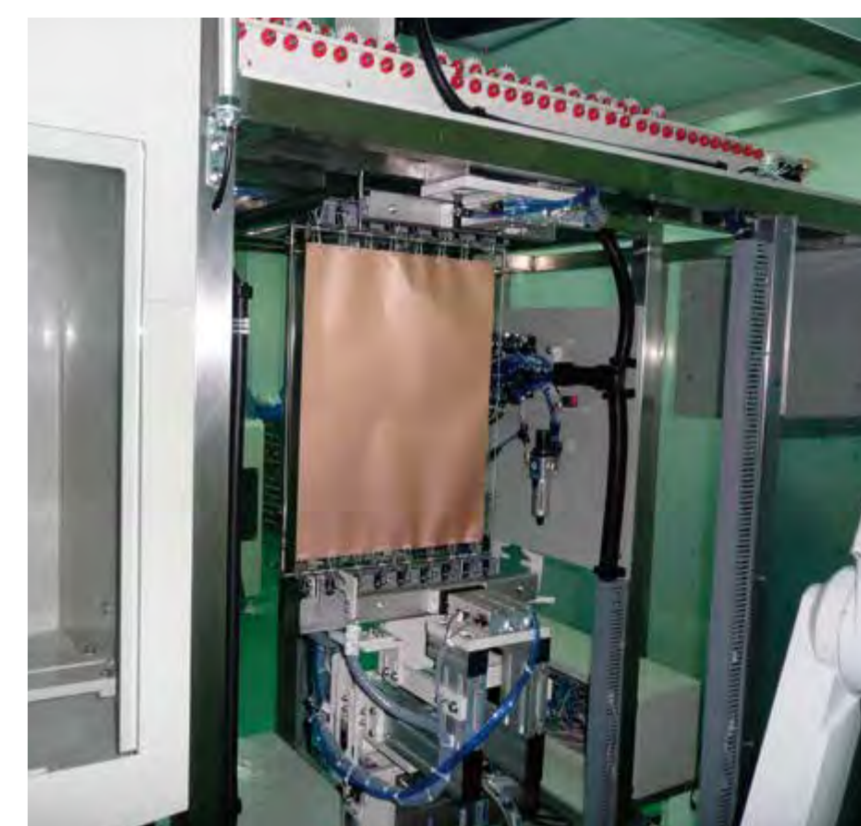
基材に負荷をかけない基板取付
